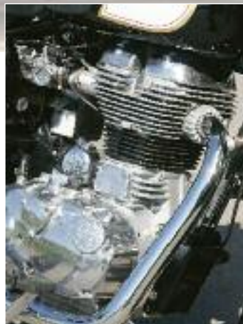
Auf Zack gebracht: 2009er Enfield-Topf mit integriertem Getriebe
