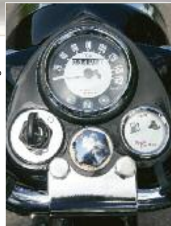
Indische Hightech: Enfield-Cockpit mit Tankuhr und Motordiagnose
